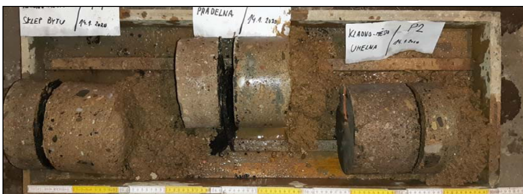
Obr. č. 5 – Diagnostický vrt do podlahy P1, P2, P3
