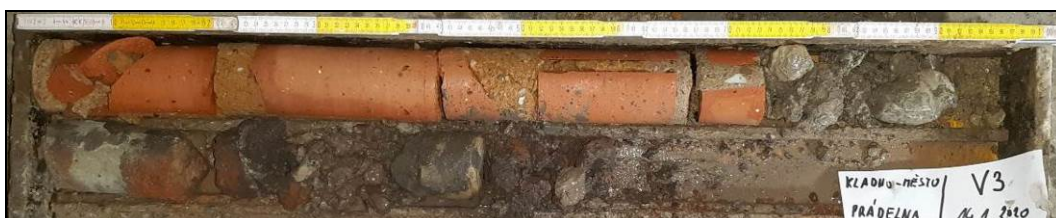
Obr. č. 4 - Diagnostický vrt V3
